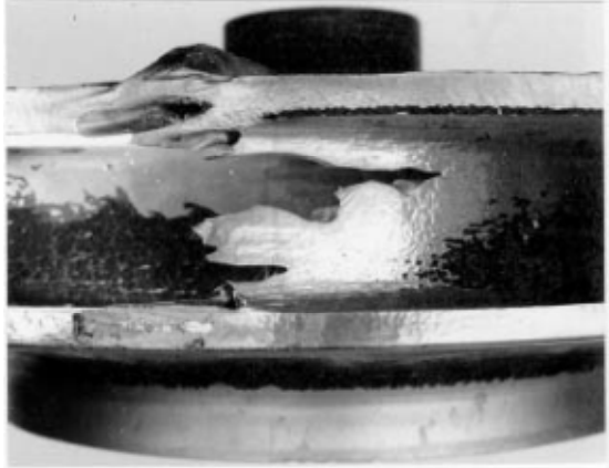
Şekil-6: Çark çıkışında meydana gelen erozyon[4]
