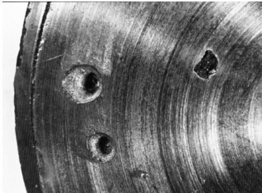
Şekil-2: Çark üzerinde meydana gelen pitting korozyonu [4]
