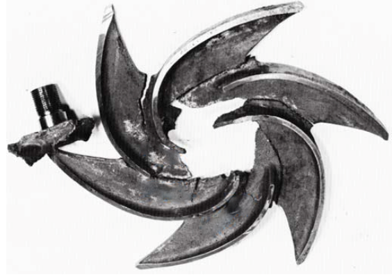
Şekil-7: Gerilmeli korozyona maruz kalmış santrifüj pompa çarkı[4]
