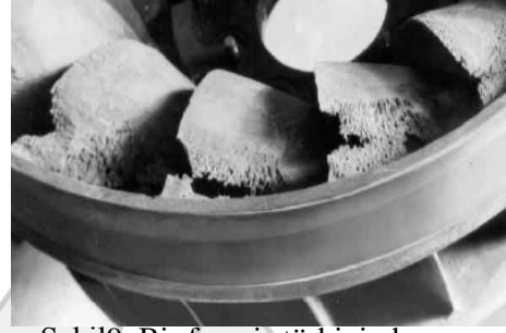
Şekil9. Bir francis türbininde kavitasyona bağlı malzeme kaybı
